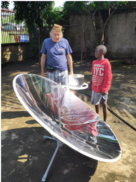
Test des von TECHshare gesponserten Solarkochers bei der Schule Linux Friends in Limbe, Kamerun: 1.5 l Wasser kochen in 25 Minuten
